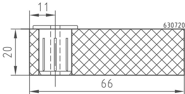
**630 720** Dämmung Blendrahmen 1340/66/20 mm mit Grundplatte 1-spurig, 6 Stück für Profil 630 019/029, 630 219/229, 630 020/030, 630 220/230, 630 022/032, 630 821, 630 075 VE 8,04 m
