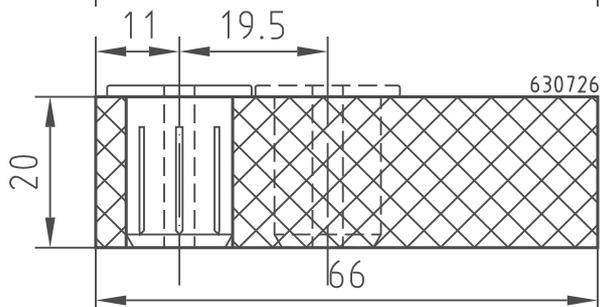
**630 726** Dämmung Blendrahmen 1340/66/20 mm mit Grundplatte 2-spurig, 6 Stück für Profil 630 021/031, 630 221/231 VE 8,04 m
