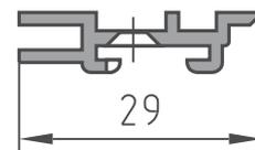
616 412 Dichtungshalterprofil HST
