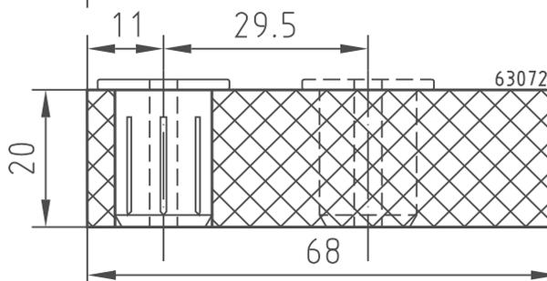
**630 799** Dämmung Rahmenverbreiterung 1700/68/20 mm ohne Lochungen und ohne Grundplatten, 6 Stück VE 10,2 m
