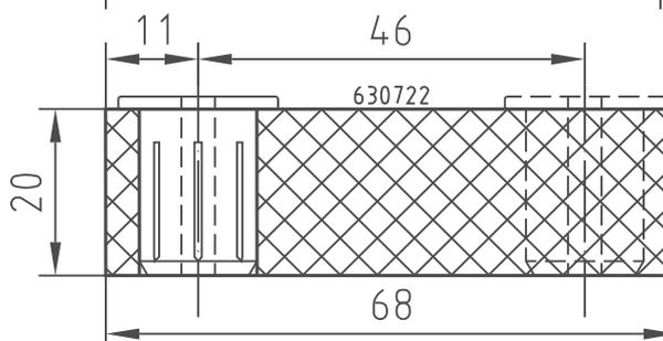
**630 722** Dämmung Setzstab 1700/68/20 mm mit Grundplatte 2-spurig, 6 Stück für Profil 630 043, 630 048, 630 248 VE 10,2 m
