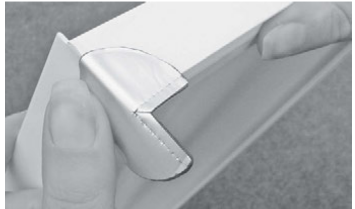
2. Anschließend um die Fuge kleben 2. Following glue around the gap
